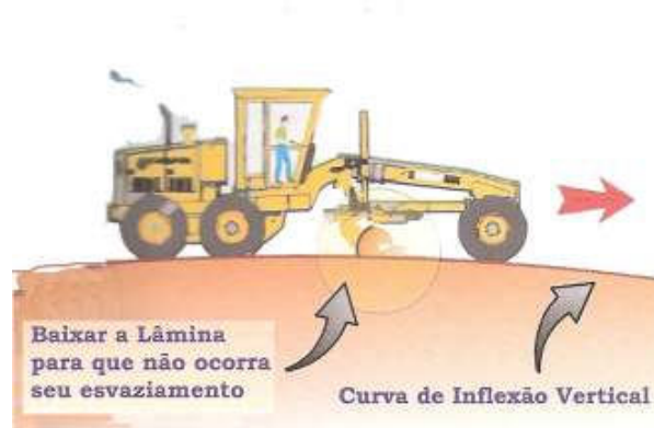
Figura 57: operação da motoniveladora em curva convexa (Fonte: Baesso e Gonçalves, 2003)
