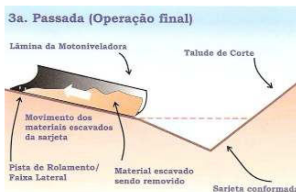
Figura 23: a terceira e última passada da motoniveladora remove todos os materiais da sarjeta que se acumularam durante o processo (Fonte: Baesso e Gonçalves, 2003)
