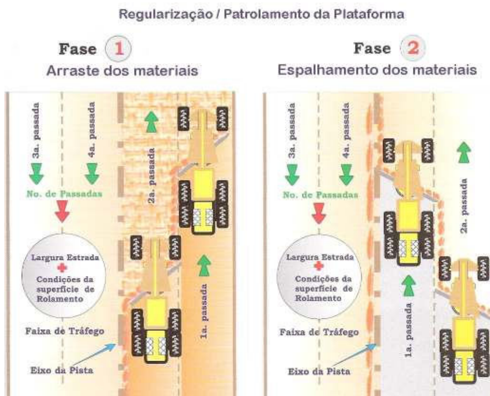
Figura 60: fase 1 e 2 do processo de regularização do pavimento (Fonte: Baesso e Gonçalves, 2003)
