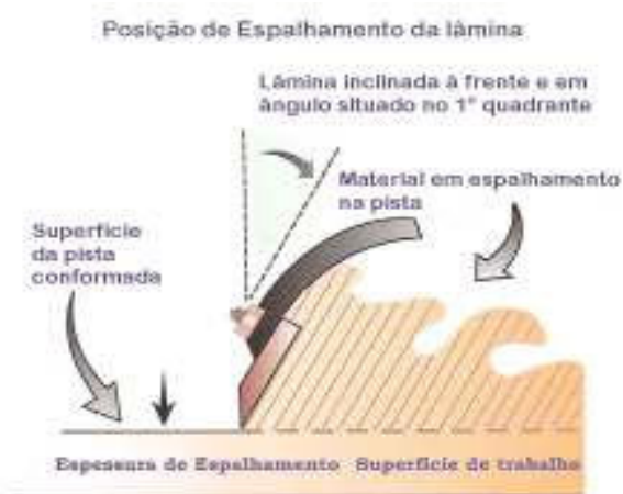
Figura 54: posição da lâmina para espalhamento (Fonte: Baesso e Gonçalves, 2003)
