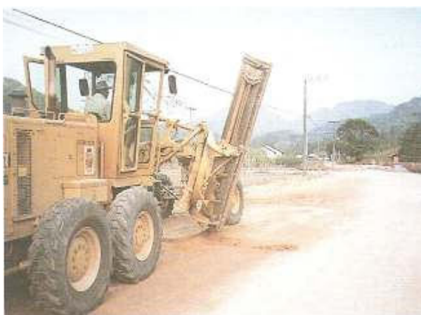
Figura 58: posição da lâmina para espalhamento (Fonte: Baesso e Gonçalves, 2003)
