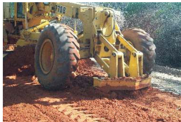
Figura 47: escarificador em ação (Fonte: Baesso e Gonçalves, 2003)
