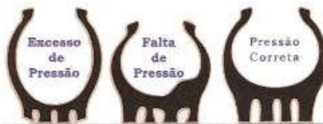
Figura 49: pressões internas nos pneus de motoniveladoras (Fonte: Baesso e Gonçalves, 2003)
