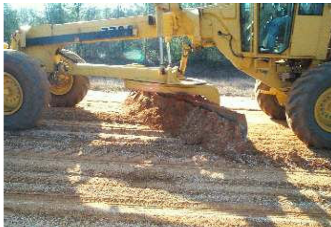
Figura 51: lâmina em posição de corte (Fonte: Joe K. Parker, 2000)
