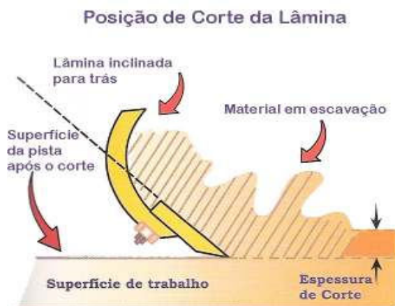
Figura 50: posição da lâmina de corte (Fonte: Baesso e Gonçalves, 2003)
