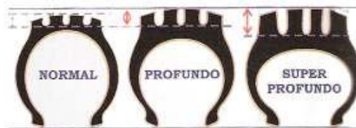
Figura 48: especificação de sulcos nos pneus (Fonte: Baesso e Gonçalves, 2003)
