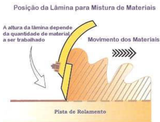
Figura 52: posição da lâmina para mistura de materiais (Fonte: Baesso e Gonçalves, 2003)
