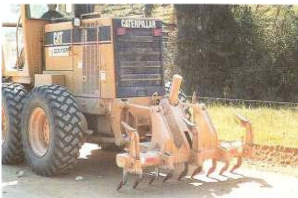
Figura 46: escarificador localizado na traseira da motoniveladora (Fonte: Baesso e Gonçalves, 2003)
