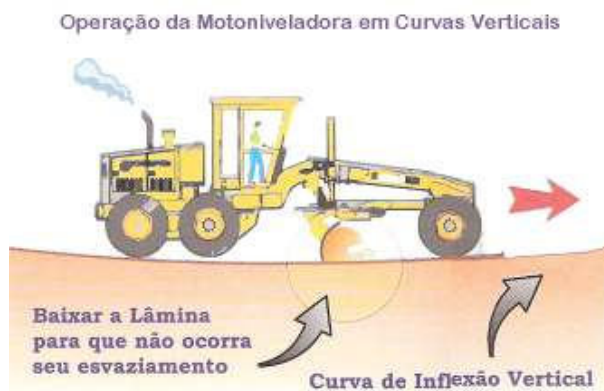
Figura 56: operação da motoniveladora em curva côncava (Fonte: Baesso e Gonçalves, 2003)
